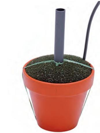
Selbst gebauter, luftbetriebener Minifilter, Durchmesser neun Zentimeter, betriebsbereit, ein Stück Kunststoffbast fixiert den Schwamm
